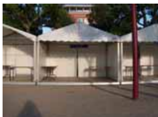
Tentoonstellingsstand met opstap van 10 cm: niet goed toegankelijk
